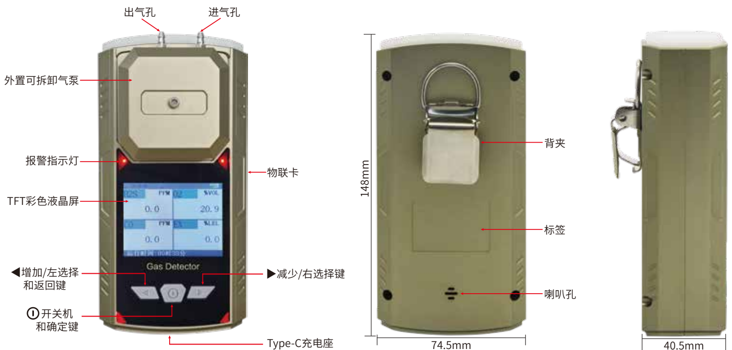
外观尺寸:148mm×74.5mm×40.5mm(长x宽x高)
